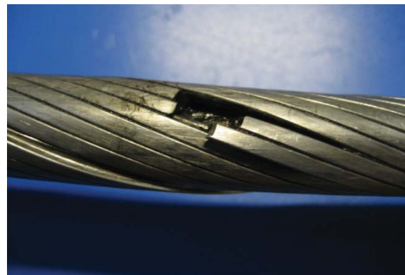
(d) Two wire breaks at 360 mm
