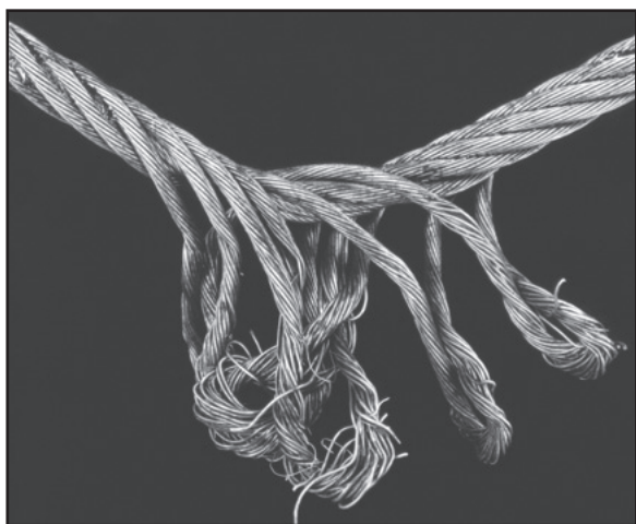
Fig. 43: Surlongueur des torons externes créée par une sollicitation en rotation du câble dans le sens ouverture.
